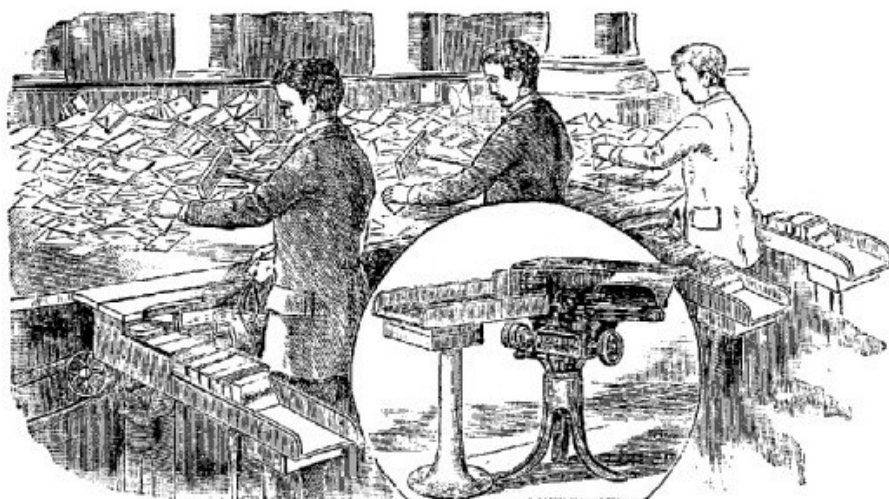
Vue d'ensemble de la machine à timbrer les lettres « Bickerdike »
