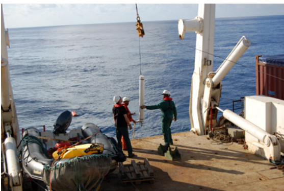
Doc 44 - Mission Eparses 2009 : Mise à l'eau d'un hydrophone Photo © Roger Venturini
